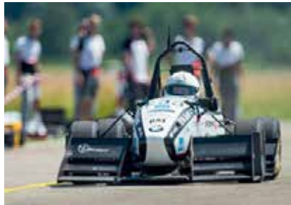
«gotthard», der neueste Rennwagen des AMZ-Teams (oben), hat vier Elektromotoren und 216 PS. Vorgängermodell «grimsel» (unten) stellte 2016 den Weltrekord in der Beschleunigung auf.
