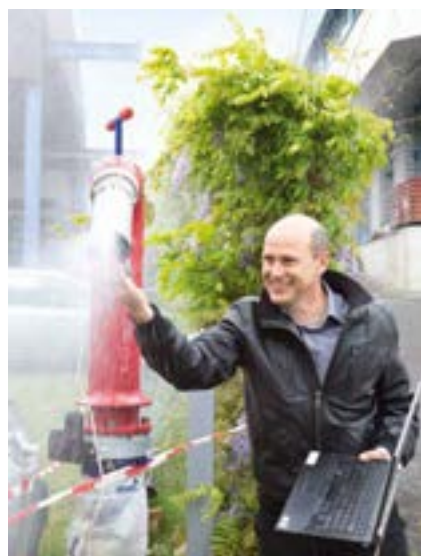
Hydrophone in Hydranten erkennen, wenn ein Leck die Geräuschkulisse im Leitungsnetz verändert.
