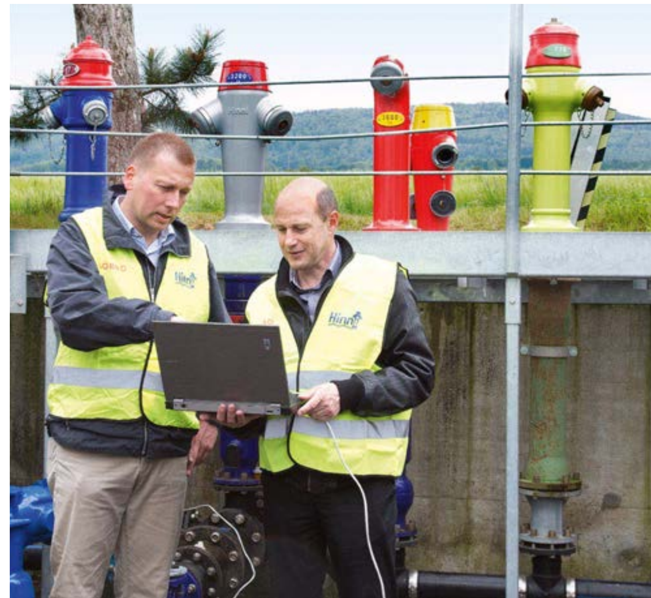
Urs Riesen (links) und Peter Sollberger beim Testen des Leckortungssystems. Die genaue Position eines Lecks berechnet sich aus der Laufzeitdifferenz der Leckgeräusche und der Schallgeschwindigkeit in den Rohren.
