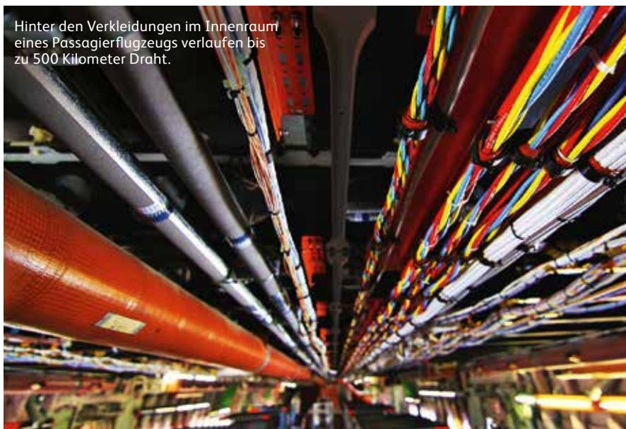
Hinter den Verkleidungen im Innenraum eines Passagierflugzeugs verlaufen bis zu 500 Kilometer Draht.
